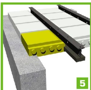
Einsetzen des fertig zugeschnittenen Füllkörpers.
