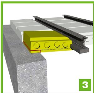
Anschließend das "liche Maß" zwischen Außenkante Trägerfuß (Beton) und Auflager (z.B. Wand) am Füllkörper anzeichnen.
