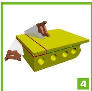
Dann den Füllkörper an der Unterseite - analog der Darstellung - zuschneiden.
